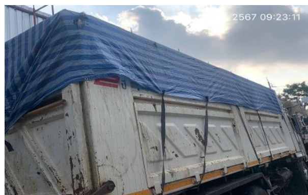
รูปที่ ก-5 รถบรรทุกที่ใช้ขนส่งวัสดุก่อสร้าง มีผ้าใบปิดคลุมอย่างมิดชิดหรือมีผนังกั้นส่วนบรรทุกโดยรอบ
