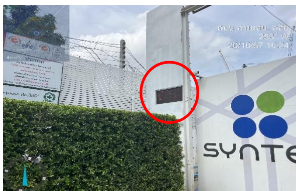
รูปที่ ก-13 เครื่องตรวจวัดฝุ่นละอองแบบพกพา บริเวณแนวรั้วโรงเรียนราชินีบน
